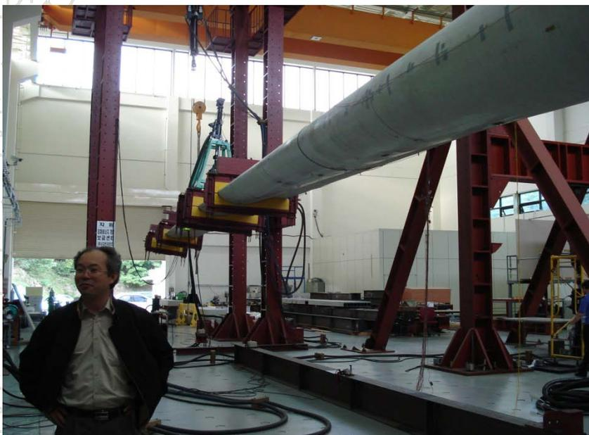
韩国针对风力发电机叶片和飞机机翼进行全尺寸性能试验的现场
